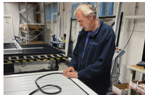
Montering av LOBAS® PORTEN ståldør.
